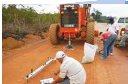
➤ Route Kogo/Akalayoung - Mesure de la portance de la partie supérieure de terrassement.
